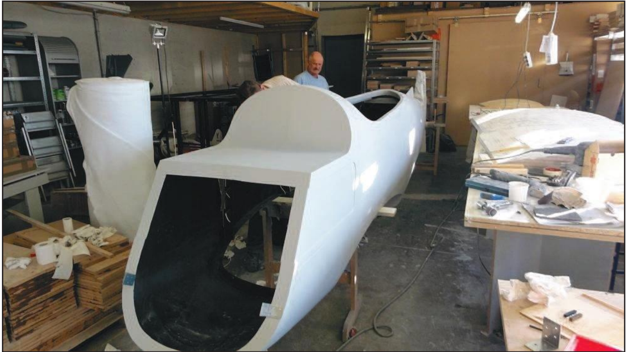
Abb. 6: Entwicklung des Rumpfes der ScaleWings Mustang FK-51 4
